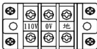
圖 3-3 AC 電源輸入介接端子配置參考
