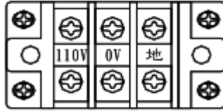
圖 3-12 AC 電源輸入介接端子配置參考
